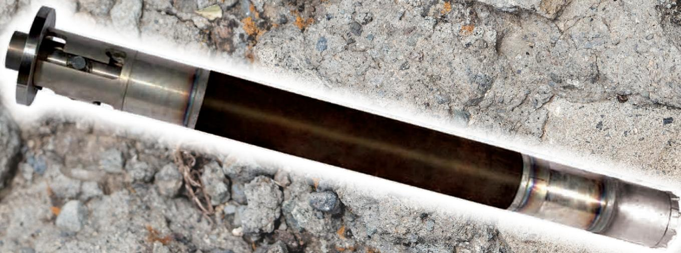
Sistema con trascinamento a fondo foro adatto alla perforazione di terreni sciolti con la presenza di trovanti o strati rocciosi.
